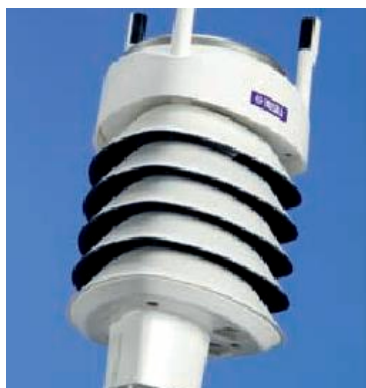
温、湿、压一体的PTU模块被内置在防辐射罩内。
