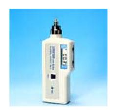
VM-63A测振仪是日本理音(RION)公司生产的测振仪,主要用于机械设备的振动位移、速度(烈度)和加速度三参数的测量,利用该仪器在轴承座上测得的数据,对照国际标准 ISO2372,利用企业、机器的标准,就可确定设备(风机、泵、压缩机、电机等)当前所处的状态(良好、注意或危险等)。
